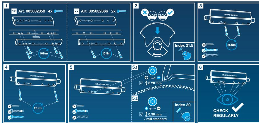
如果精梳机首次配备 INOACOMB flex，必须先安装配重。所有重装针布不受此限制，前提是已安装适用于 INOACOMB flex 的正确配重。因此，安装过程因情况而异。必须遵循精梳机的使用说明书。INOACOMB flex 的安装手册应理解为对精梳机使用说明书的补充。
