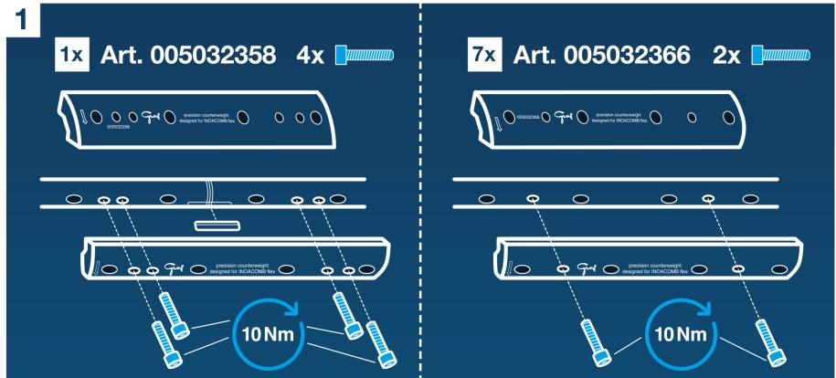
由于 INOACOMB flex 的轻质结构, INOACOMB flex 圆梳的重量低于传统梳子的重量。为了实现最佳机器性能 (少振动), 必须使用适当的配重。此外, INOACOMB flex 配重在开发时还考虑了承受加载梳子的轴的扭转会力。
