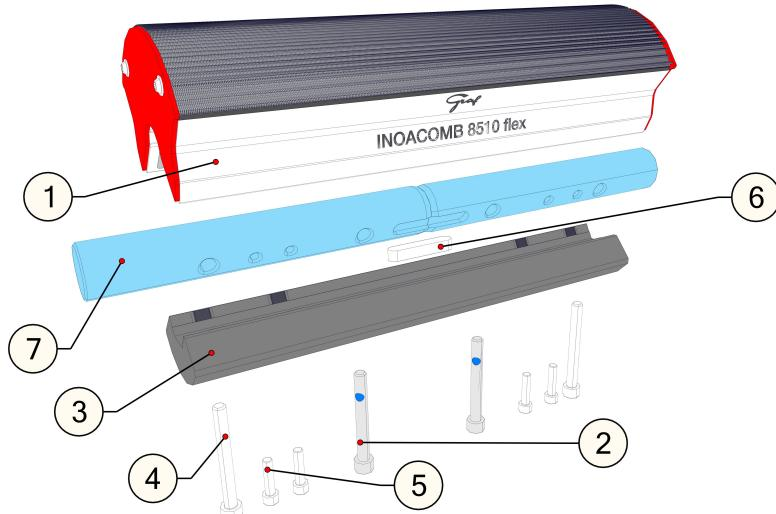
对于耦合点，应使用耦合点的特殊平衡重，通过 2 个额外的紧固螺钉 (5) 和楔块 (6) 安装，使耦合点固定。
